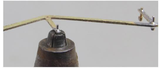
Schrauben in einer Wanne mit einer Pinzette in die Verstrebung einfädeln und verlöten. Der Verlust der Schrauben bleibt so überschaubar. Die bessere, aber auch noch zeitintensive Methode ist, die Schrauben mit der Pinzette in einen Stiftenkloben zu stecken, durch Drehen zu fixieren und dann wie oben zu verfahren.
