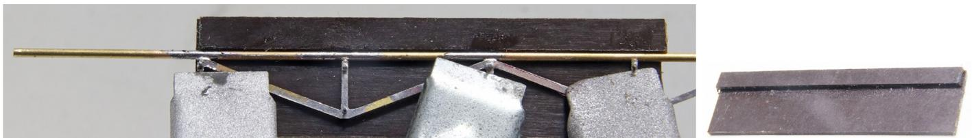
Einen der beiden Pertinaxstreifen an den Rand der Lehre mit dünnem doppelseitigem Klebeband (von 3M oder Tesa) befestigen. 1mm Draht mit Hilfe der Lehre so an die Verstrebung löten, dass die Seite mit der Vorkopfbohrung 19,5mm über die letzte Verstrebung hinausragt. Das zweite Seitenteil wird spiegelsymmetrisch angefertigt.
