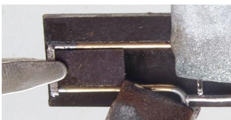
Endwinkel mit der halbrunden Aussparung unter den oberen und stumpf vor den unteren Draht löten. Verbindungssteg anlöten, Schraube im oberen Bereich.
